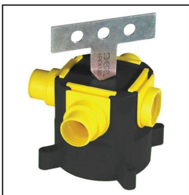
Коробку можно использовать в качестве потолочной для подвески и подключения светильников. Для этого надо в нее установить Крюк 5301 (см. раздел «Аксессуары»), сделав ножом в дне коробки с внешней стороны по утончению сквозной прорез длиной 20 мм. С усилием вставить крюк в дно коробки. Затем одеть изолятор на крюк. Максимальная нагрузка на крюк – 15 кг.
